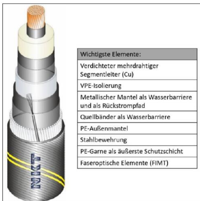
Schematische Darstellung des Seekabels (Quelle: NKT)
